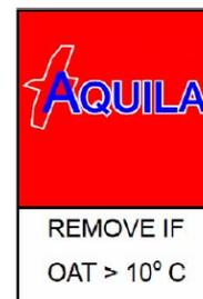
Bei Außentemperaturen kleiner +5°C (41°F) am Startplatz (GND) kann alternativ eine Kühlerabdeckung „Schweiz“ installiert werden. Sie hat eine vergrößerte Abdeckfläche und ist damit wirksamer. Folgendes Hinweisschild muss auf der Kühlerabdeckung angebracht sein:
