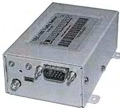
Wird ein Traffic-Sensor TRX-1500 der Firma Garrecht in das Flugzeug AQUILA AT01 eingebaut, ist diese Ergänzung anwendbar und muss in den Abschnitt 9 des Flughandbuches aufgenommen werden. Informationen dieser Ergänzung ergänzen oder ersetzen ggf. die Abschnitte des Basis-Handbuches.
